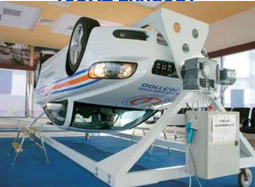
Προσομοιωτής ανατροπής Roll over car (Σουηδία)
